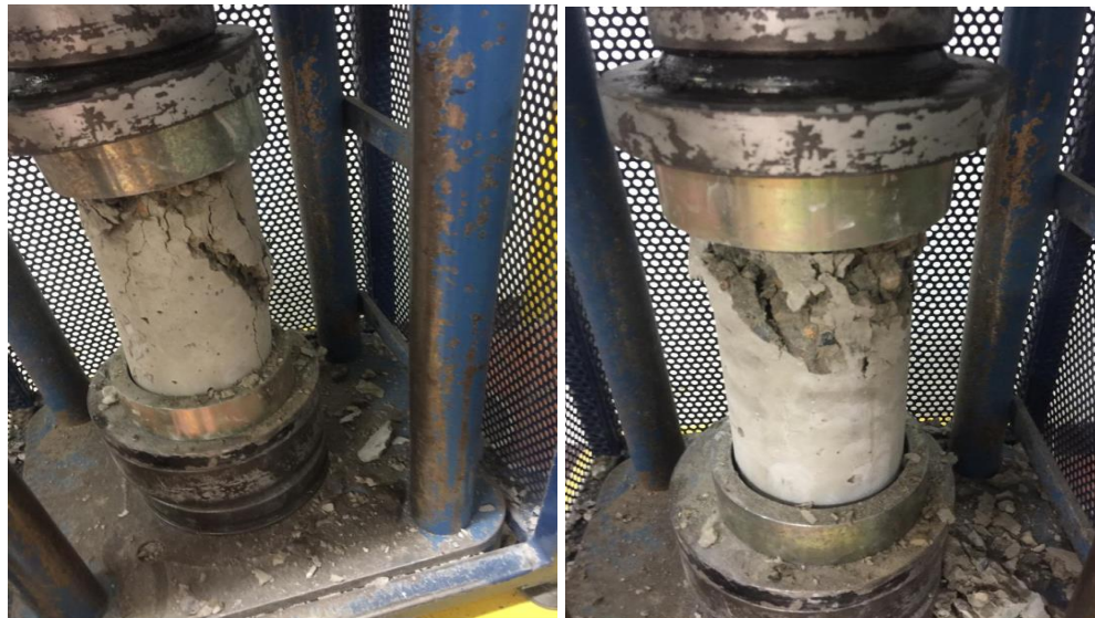
Figure 23- FALLA DE CILINDROS A COMPRESION
