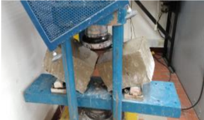
Figure 35-Falla de vigas a flexión sin fibras (28D)
