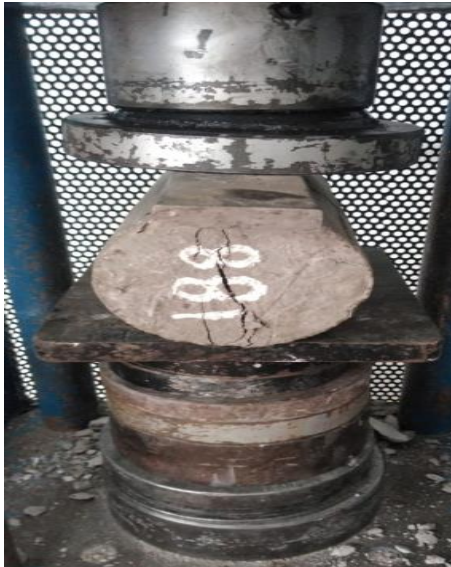
Figure 33-falla de cilindros con 188g de fibras a los 28D
