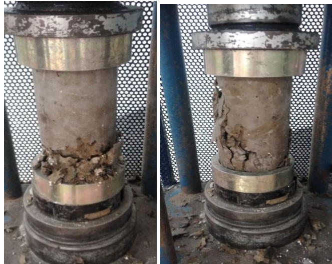
Figure 27-Falla de cilindros a compresión sin fibras a los 28 D
