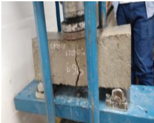
Figure 36- falla de viga a flexión con 96 g a los 28D
