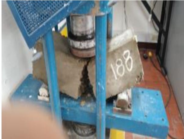
Figure 37-Falla de vigas a flexión con 188 (28D)
