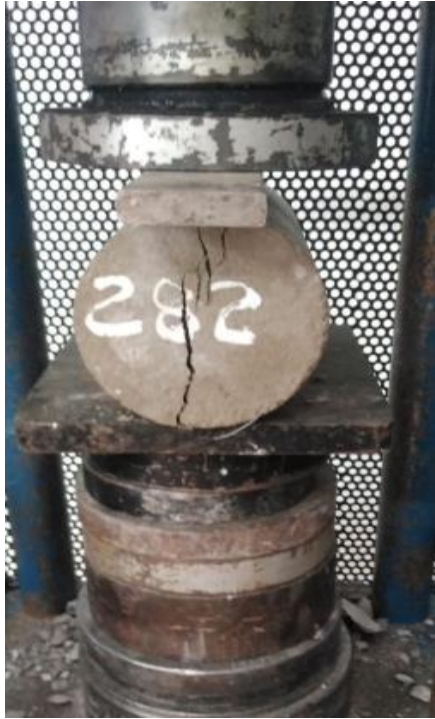
Figure 34-Falla de cilindros a tracción con 282 g de fibras a los 28 D
