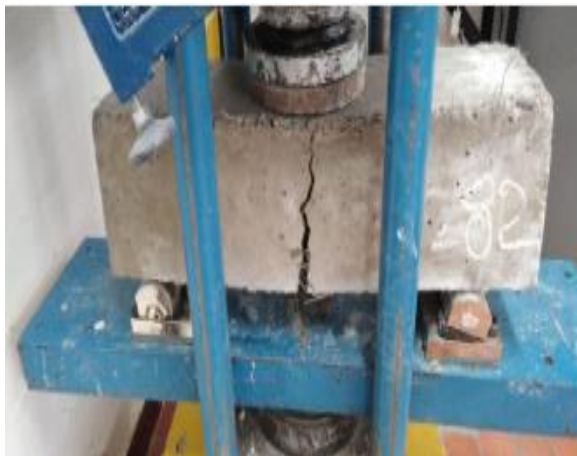
Figure 38-Falla de vigas a flexión con 282(28D)
