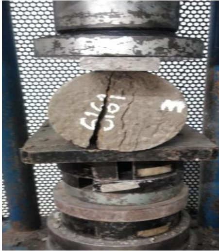
Figure 32-falla de cilindros con 98 g de fibras a los 28D
