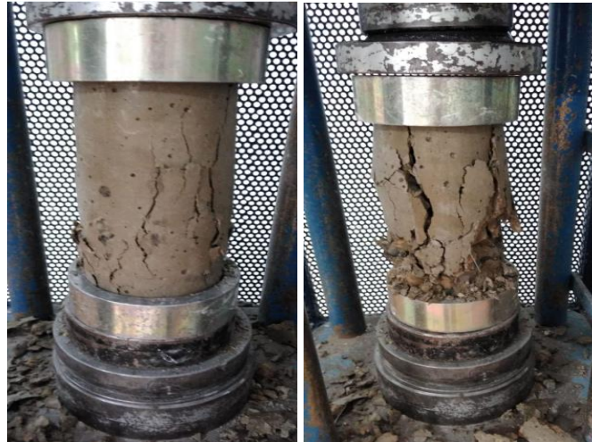
Figure 28-falla de cilindros con 96 g de fibras a los 28D
