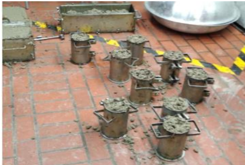
Figure 19- Fundida de cilindros y vigas
