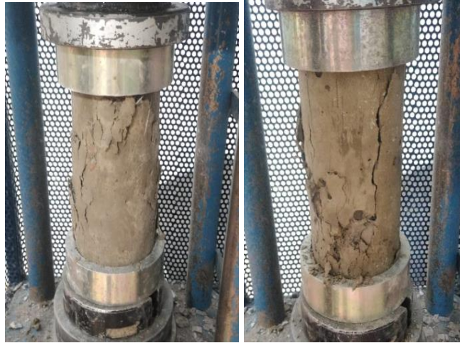
Figure 26-falla de cilindros con 282 g de fibras a los 7d
