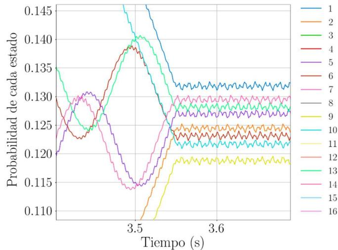
**Figura 10. Acercamiento del fenómeno de teleportación cuántica al final del algoritmo para 4 qubits con  $\alpha = \beta = 1/\sqrt{2}$  mostrando la convergencia de los estados en los valores de probabilidad esperados.**
