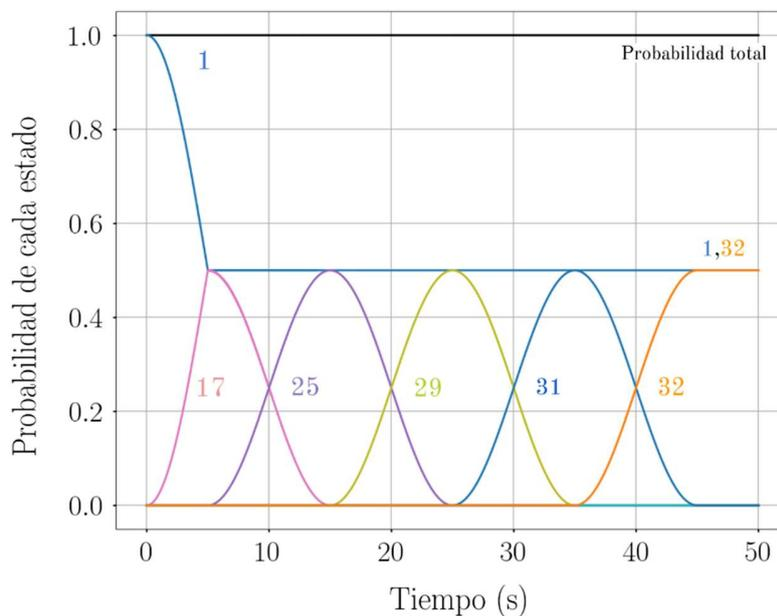
**Figura 17. Resultado del código de  $N=5$  qubits simulando el estado cuántico de Greenberger-Horne-Zeilinger, el cual empieza con el estado base puro y termina con una superposición del estado base y el estado de mayor energía. Los números representan el estado al que la línea pertenece; los otros estados no forman parte del proceso.**
