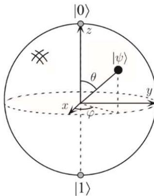
**Figura 1. Esfera de Bloch. Visualmente, el estado  $|\Psi\rangle$  se puede determinar gracias al valor de los ángulos  $\theta$  y  $\varphi$ , con esto se puede determinar cualquier estado de un qubit (24).**
