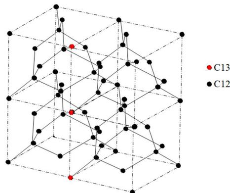
**Figura 3. Sistema físico utilizado. En esta estructura de diamante, se sustituyeron tres átomos de C12 por otros de C13. Debido al spin que tienen estas partículas, se pueden aplicar campos magnéticos para interactuar con ellos (25).**
