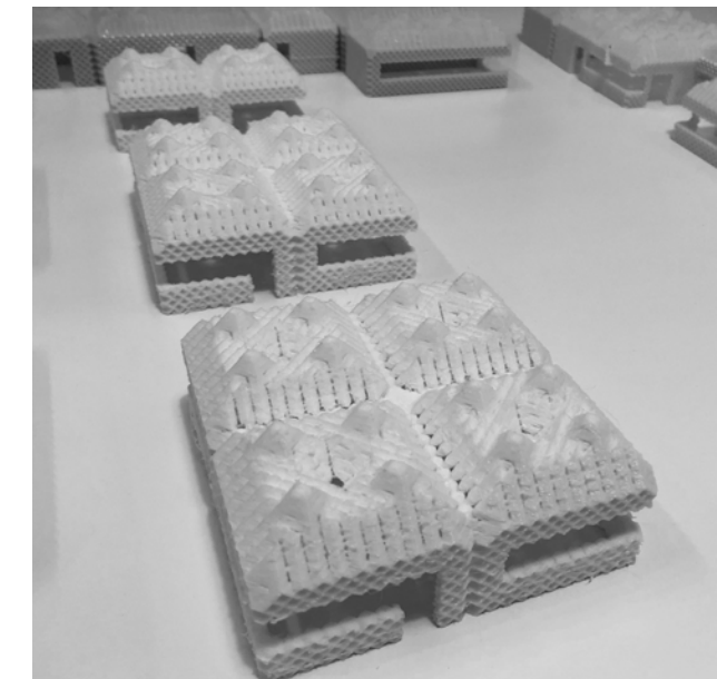
Detalle de módulos impresos en 3D FDM. Permite estudiar volúmenes básicos y la vibración de la luz que generan las lonas en el interior y el exterior.
