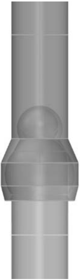
Vista superior de detalle de acoplamiento entre barras
