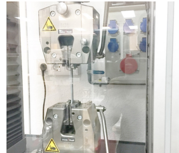
Máquina de Ensayo Universal en ensayo a tracción
