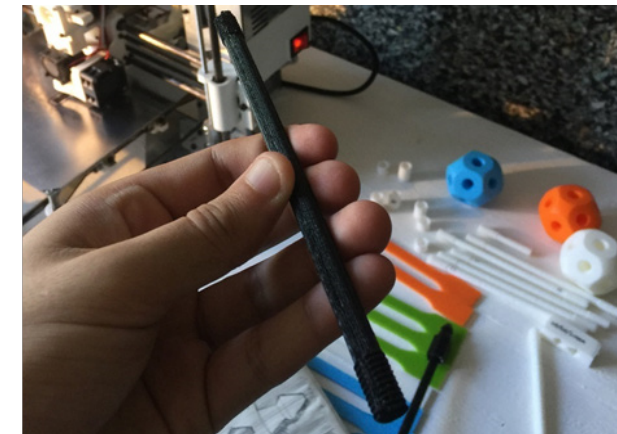
MK27. Fotografía de barra roscada imprimida en 3D.
