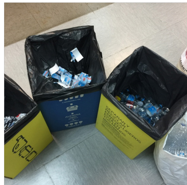
Reciclado de botellas de PET. Por un lado, se separa el papel de las botellas para posterior reciclaje. Por otro lado, se almacenan los tapones y asas de botellas de HDPE (Polietileno de Alta Densidad). Finalmente, las botellas limpias se preparan para el triturado y transformación en granza.
