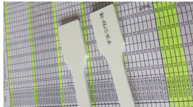
Probetas imprimidas en 3D con códigos de configuración
