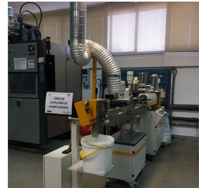
Línea completa de compounding para producción de granza.
