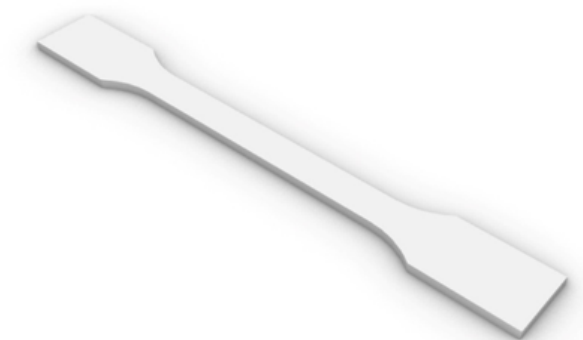
Modelado de probeta de ensayo ISO 3167 A
