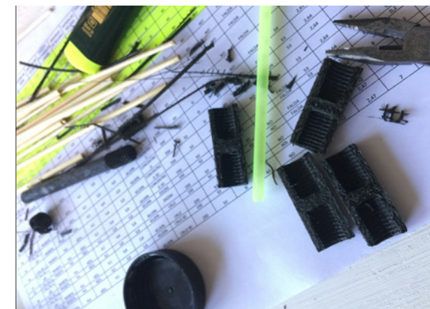
MK27. Fotografía de diferentes piezas de conexión imprimidas en 3D entre barras para estudiar las tolerancias admisibles. Finalmente se descarta el sistema roscado por la necesidad de precisión (a costa de velocidades de impresión), índice de fallo y posibles problemas de tolerancias que puedan generar barras más largas que otras y por tanto descompensar la estructura.
