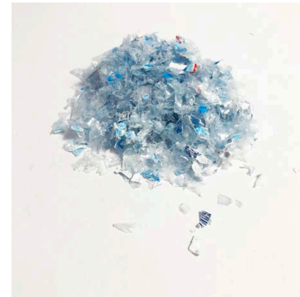
Reciclado de botellas de PET. En esta fotografía se muestra el resultado de granza (todavía con algunos restos de papel en las muestras iniciales). El PET de las botellas se introduce en el molino que tritura las botellas hasta un tamaño que pase por el tamiz. Estas escamas son succionadas por una turbina que las deposita en una campana para almacenamiento y transformación posterior.
