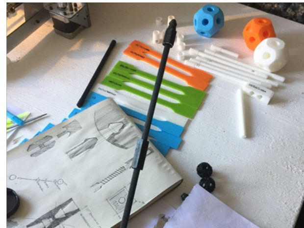
MK27. Fotografía de dos barras imprimidas en 3D acopladas mediante rosca y extremo para conexión a nudo. Las barras no muestran holgura en las conexiones.
