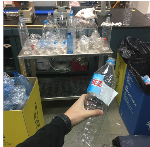
Reciclado de botellas de PET. En primer lugar las botellas se someten a una limpieza básica neutra (agua y aire comprimido). Se seleccionan para asegurar que el material es PET (en sus variantes) y se procede a la separación de los materiales que las componen.
