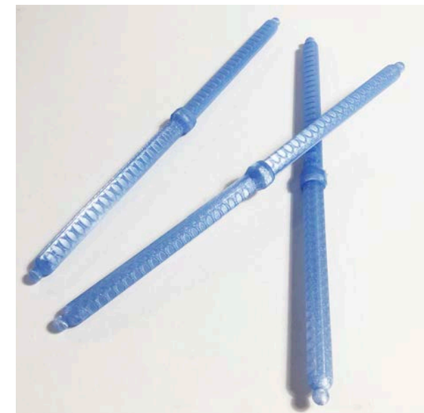
Fotografía de barras acopladoras y extensoras formando piezas de mayor longitud impresas en 3D con PET reciclado.
