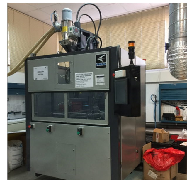
Máquina de inyección vertical de doble estación para fabricación por moldes.
