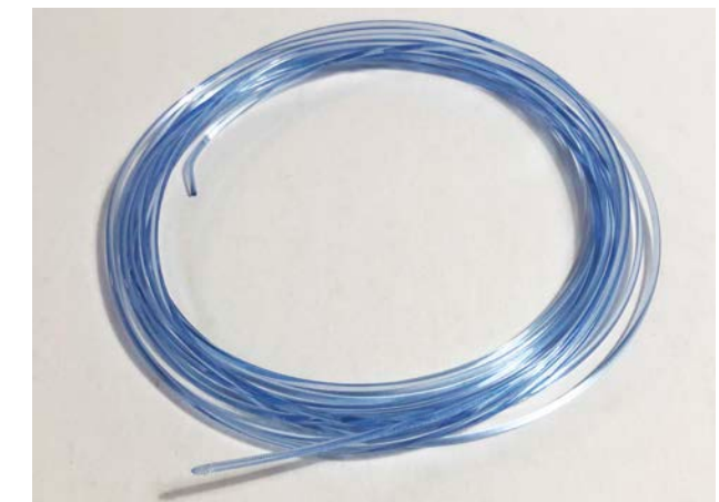
Fotografía de filamento a partir de botellas de PET reciclado.
