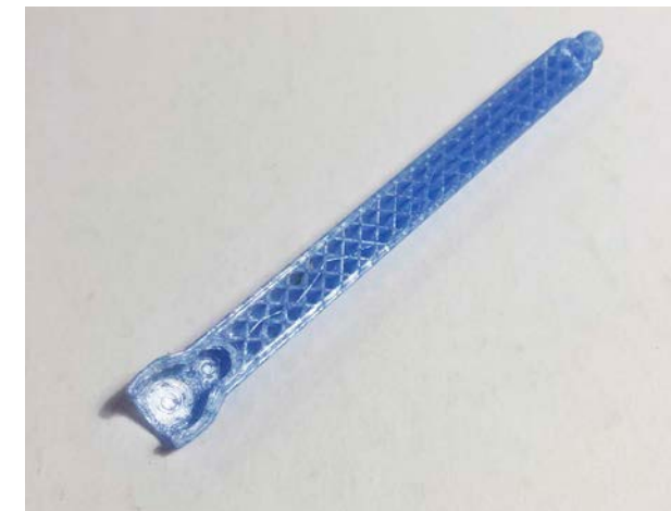
Fotografía de una barra acopladora fabricada en PET reciclado con la mesoestructura interior visible.
