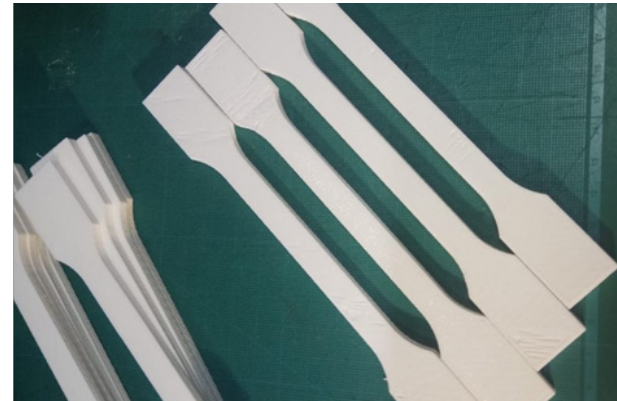
Probetas de ensayo impresas en PLA
