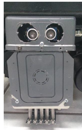
Fig. 35: Ajuste de distribución y altura de sensores IR Line tracking
