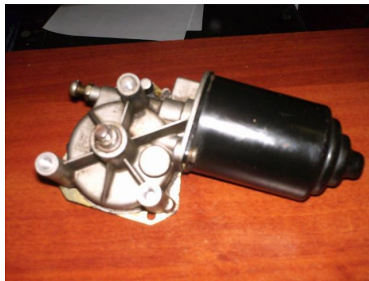
Fig. 5: Motores DC a 12 V, 80 W
