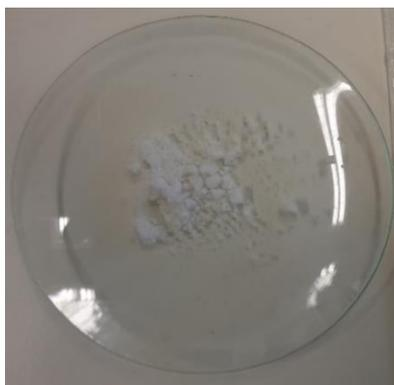
**Figura 9.** Morfología del compuesto [TPrA][Mn(dca)<sub>3</sub>] sintetizado.
