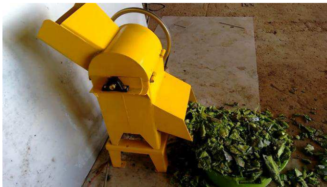
Figura 20 - Equipamento mecânico para fracionar os cladódios. Fonte: ( https://i.ytimg.com/vi/T7NZp2KEQwM/maxresdefault.jpg ).
