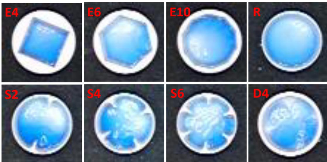
**Abbildung 7.7** Bestimmte mittlere Mischzeiten für verschiedene Mischkammergeometrien (Viereckig (E4), Sechseckig (E6), Zehneckig (E10) Rund (R), 2 Schikanen (S2), 4 Schikanen (S4), 6 Schikanen (S6), Deltaform mit 4 Schikanen (D4)). Die Messungen wurden in Dreifachbestimmung durchgeführt und unabhängig von einander mit dem VA und dem entwickelten Homogenitätskriterium ausgewertet. Die Fehlerbalken stellen die Standardabweichung der Dreifachbestimmung dar.
