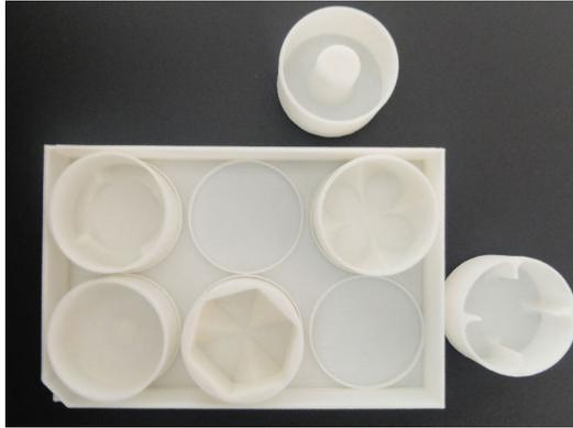
Abbildung 7.1 Schüttelplatte mit verschiedenen Mischkammergeometrien (Raddatz *et al.* 2017).
