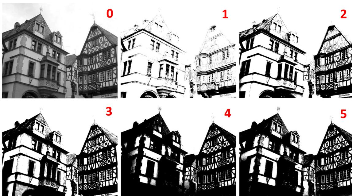
**Abbildung 3.8** Binärbilder generiert unter Verwendung verschiedener Schwellenwerte. (0) Originalbild (wikipedia.org2); (1) Schwellenwert: 40; (2) Schwellenwert: 70, (3) Schwellenwert: 110, (4) Schwellenwert: 160; (5) Automatischer Schwellenwert nach Otsu-Verfahren.
