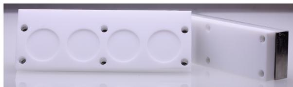
Abb. 3.2: Teflonform zur Probenherstellung für Rheologiemessungen.
