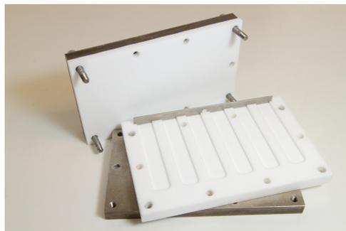
Abb. 4.3: Teflonform für die Probenherstellung der Silicone.
