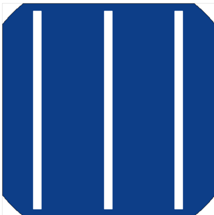
Abb. 3.10: Schemazeichnung des Sieblayouts des ersten Druckes beim Dual Print. Es werden nur die Busbars mit einem Sieb gedruckt. Da die Busbars keinen Kontakt zum Emitter benötigen, können spezielle Silberpasten verwendet werden, die die Rekombination unter dem Metallkontakt reduzieren.
