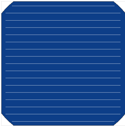
Abb. 3.6: Schemazeichnung des Sieblayouts des ersten Druckes beim Print-on-Print. Es werden nur die Kontaktfinger auf die Zellvorderseite gedruckt. Es können schmale Sieböffnungen verwendet werden, da mögliche Fingerunterbrechungen im zweiten Druckschritt mit großer Wahrscheinlichkeit eliminiert werden.
