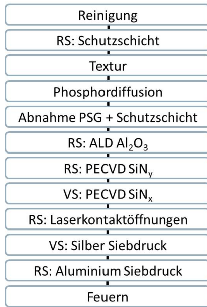
Abb. 2.2: Prozessfluss mit Auflistung der Hauptelemente des PERC Basisprozesses am ISFH.
