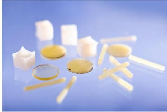
Abb. 1: Komposit-Prüfkörper für mechanische Untersuchungen.<sup>[17]</sup>
