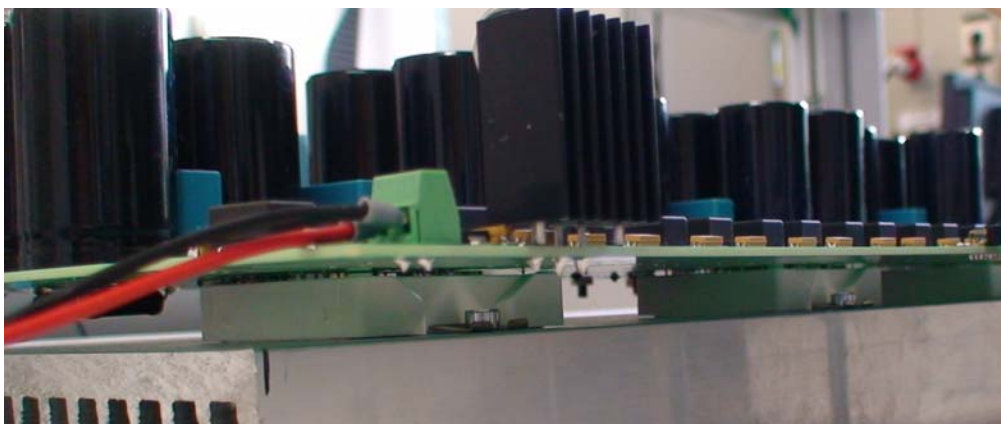
(c) Halbleitermodule zwischen Kühlkörper und Platine
