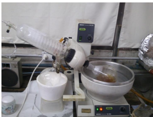
Figura 3.3. Deshidratación de la resina
