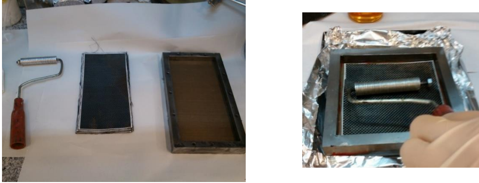
Figura 5.1 Rodillo metálico, fibras de carbono y molde metálico utilizados para el procesamiento de los materiales compuestos
