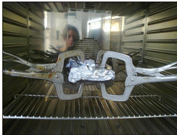
Figura 4.5 Molde cerrado con pinzas dentro de la estufa
