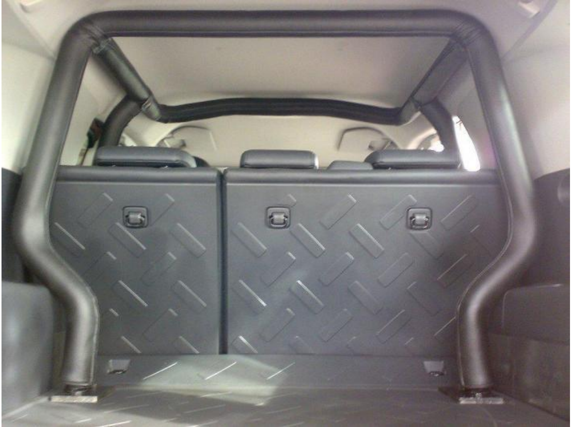
Fig. 7 – Estructura de seguretat interior fixada a la carrosseria (Font: Escapes Mendoza)
