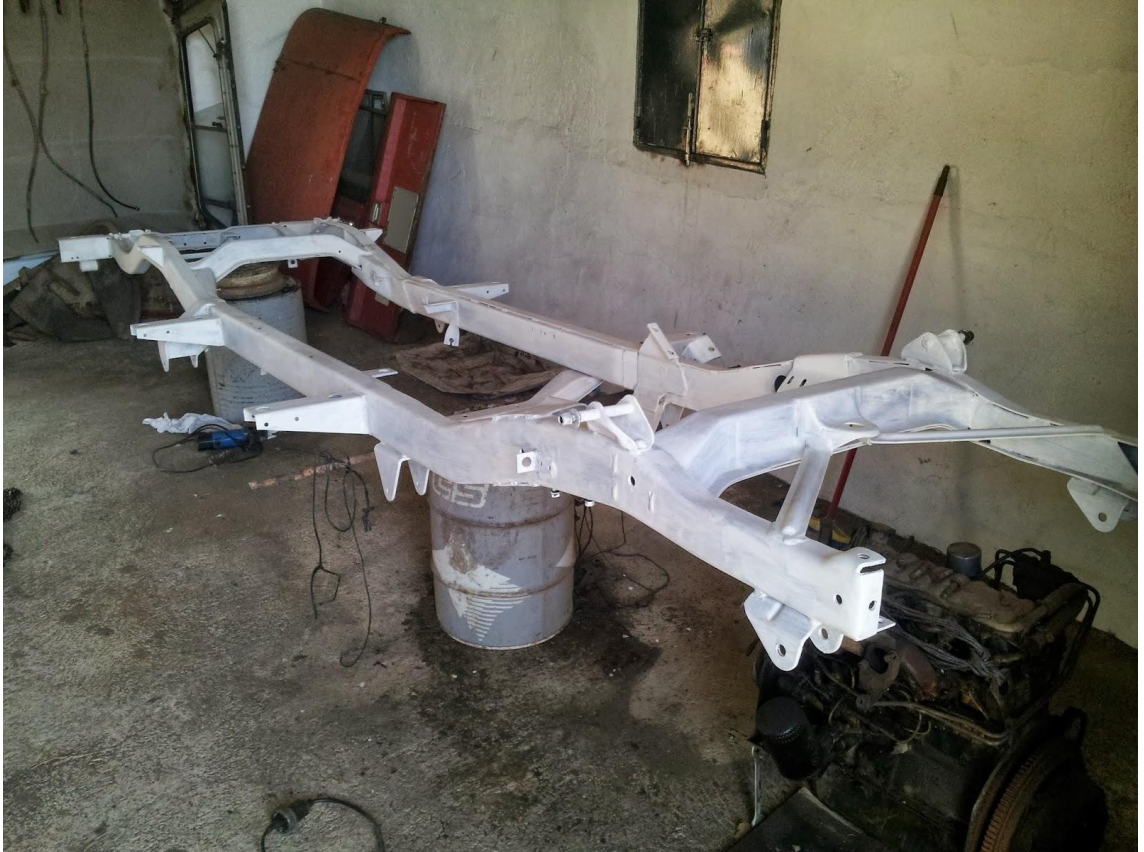
Fig. 8 – Xassís del vehicle on es pot apreciar la distribució de llarguers i travessers (Font: Bloc de restauració Jeep Comando. Autor: J.Sánchez)
