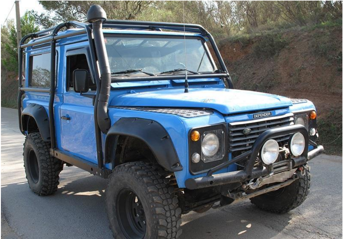
Fig.6 – Estructura de seguretat exterior fixada al xassís del vehicle (Font: MC Enginyeria)
