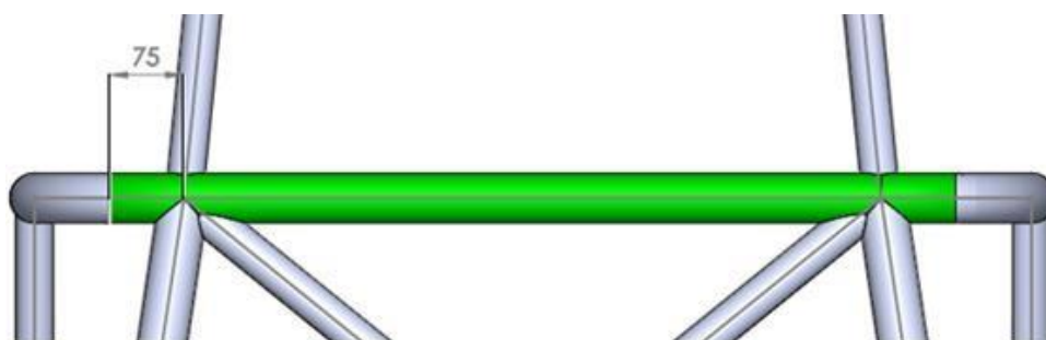
Fig.43 – Vista en planta de la zona d'aplicació de la càrrega vertical (Font: Reglament FIA)
