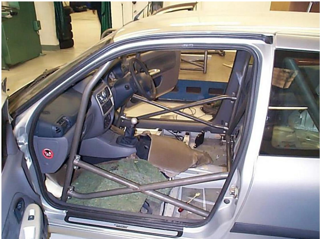
Fig. 16 – Reforç que dificulta l'accés al conductor (No es possible homologar en vehicle de carrer) (Font: MC Enginyeria)
