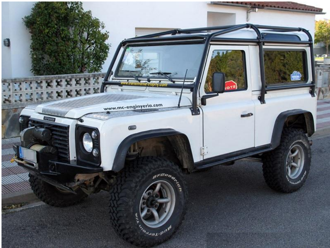
Fig.5 – Estructura de seguretat exterior fixada a la carrosseria (Font: MC Enginyeria)
