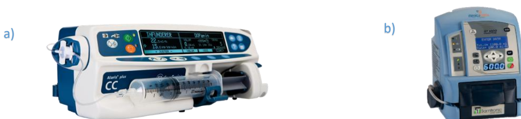
Figura 3.2 (a) Bomba d'infusió tipus xeringa. S'utilitza per volums petit i infusions a baixa velocitat. (b) Bomba d'infusió peristàltiques. Permeten gestionar volums grans prou grans com per alimentar un pacient.
