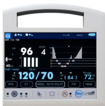
Figura 4.8 Monitor TOF-Cuff amb la pantalla marcant un TOF-ràdio de 96 corresponent a la fase de recuperació i un valor de TOF count de 4. A la dreta de la pantalla es presenta el gràfic de la evolució del BNM des de l'inducció.
