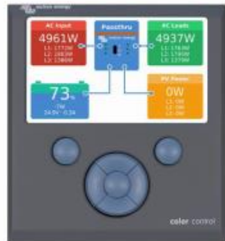
Panel Color Control con una aplicación FV
