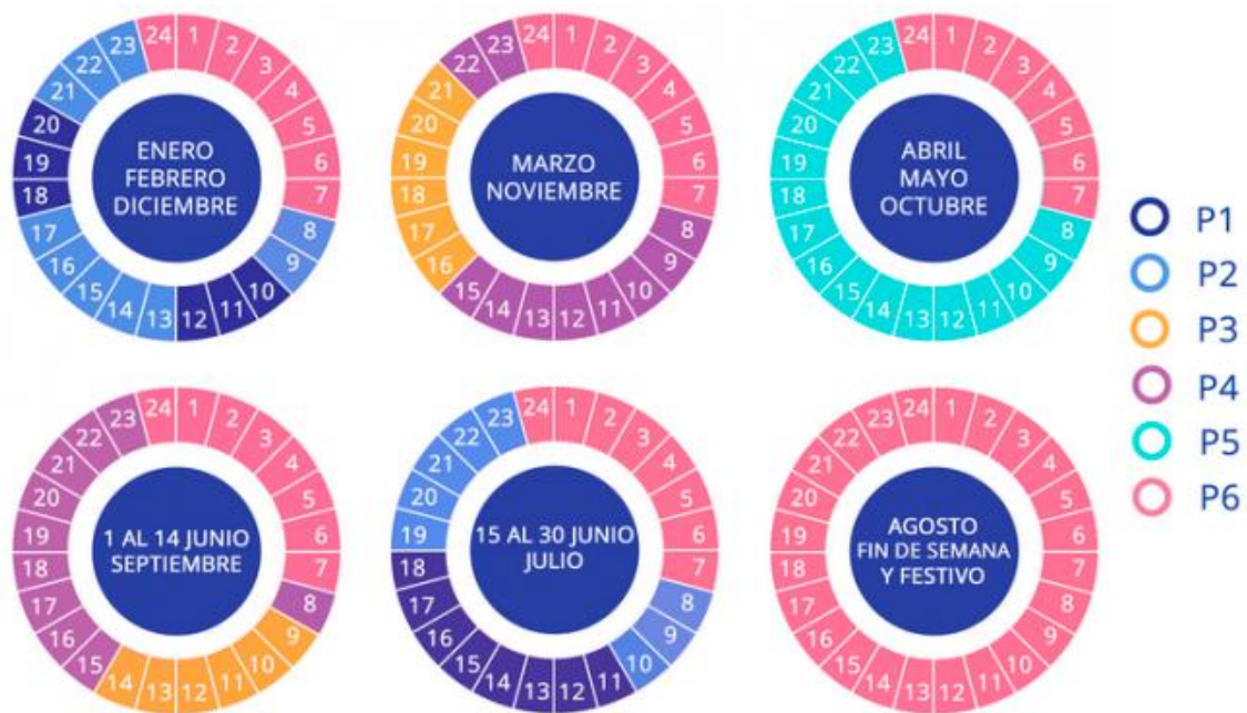
Figura 6.3.2.1 Horario de Tipos de Periodo para la Tarifa 6.1A en la Península publicado por Aura Energía.
