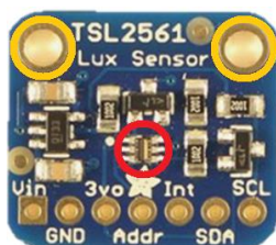
Ilustración 66: Posición del sensor TSL2561 y de los taladros de fijación en la placa Adafruit.
