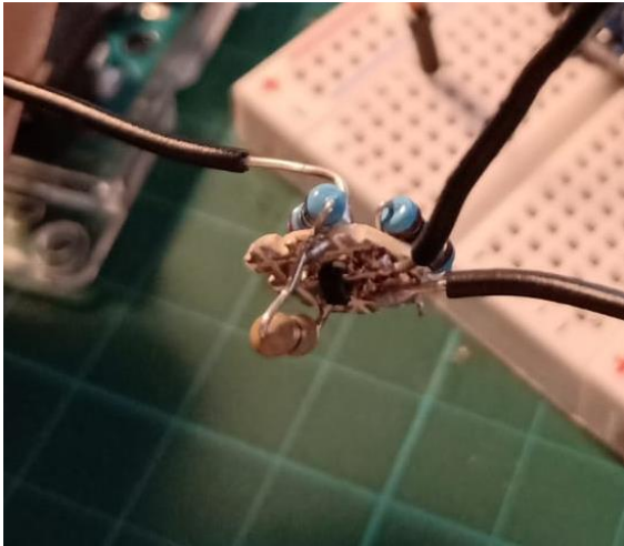
Figura 148. Circuit resultant de soldar es components per reiniciar la placa.
