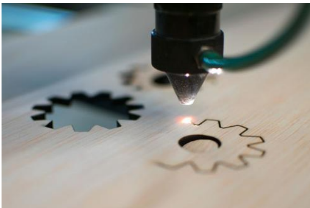
Figura 97. Mètode del tall làser per crear peces en forma d'engranatge a partir d'una planxa de fusta.
