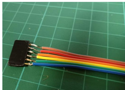
Figura 142. Soldadura de varis cables amb pins femella.
