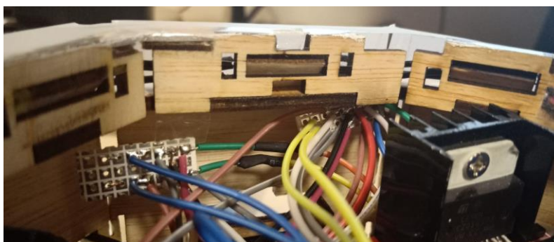
Figura 147. Resultat de soldar en una sola línia l' Vcc i GND dels sensors làser.
