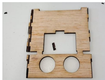
Figura 133. Peça corba trencada per culpa d'un mal disseny del patró de cobertura.
