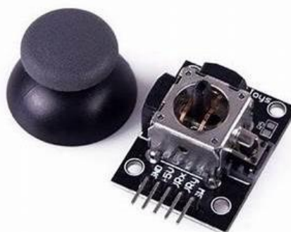
Figura 158. Estructura interna d'un joystick.
