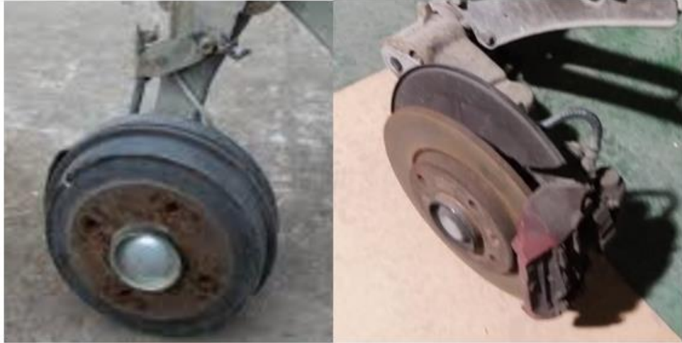
Figura 6. Comparativa frens posteriors abans (esquerra) i després de la reforma (dreta). (Font: Fòrum Club 205 España [4])
