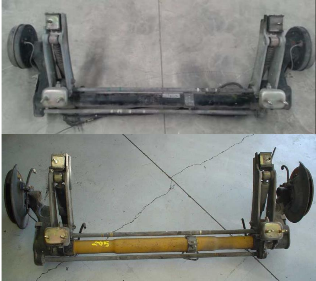
Figura 2. Eix abans de la reforma (superior) i eix després de la reforma (inferior). (Font: Fòrum Club 205 España [4])
