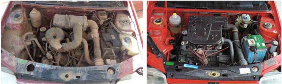
Figura 1. Imatges motors, abans de la reforma (esquerra) i després de la reforma (dreta). (Font: Fòrum Club 205 España [4])
