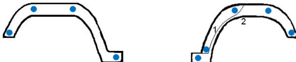
Figura 16. Esquema de la ubicació dels cargols per al muntatge dels aletins. (Font: Elaboració pròpia)
