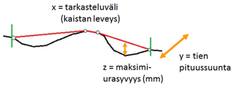
Kuva 1. Urasyvyyden laskennan periaate laserkeilauksessa. Tarkasteluvälille (vihreiden viivojen väli) asetetaan kuvitteellinen kiristetty lanka (punainen viiva). Maksimiurasyvyys on suurin pystysuora etäisyys tien pinnasta tähän lankaan. (Vuorimies et. al. 2019)
