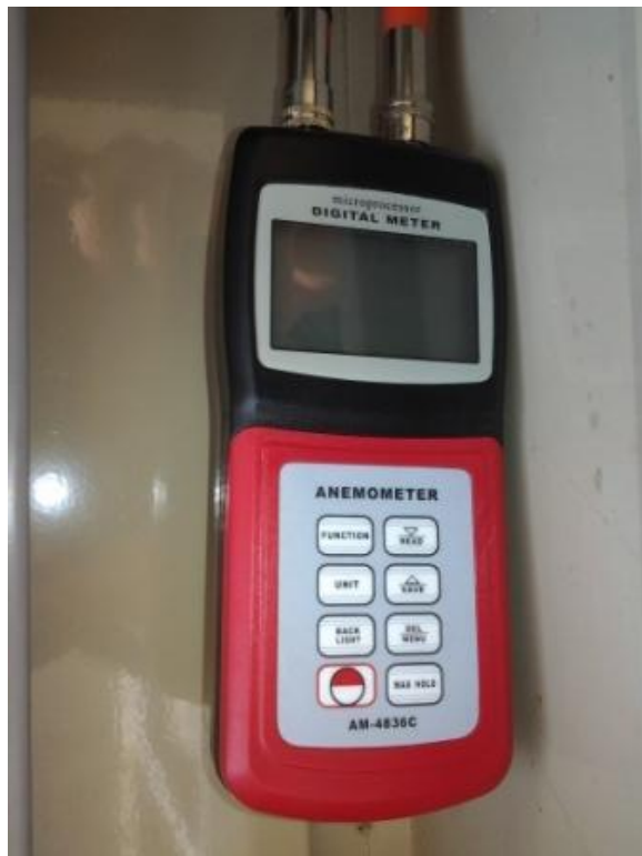
PROVA (AV M-07) anemometer.
