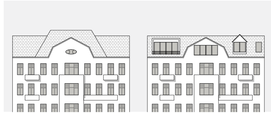
Historische Dachform (links) und ausgebauter Dach mit verändertem Schmuckgiebel und störenden Dachaufbauten (rechts)
