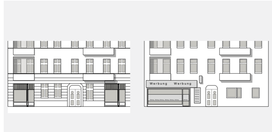
links: ursprüngliche Erdgeschossgliederung - rechts: Veränderung der Schaufensterproportionen und übermäßige Werbeanlagen bzw. Umbau zur Wohnung mit untypischen Fensterformaten
