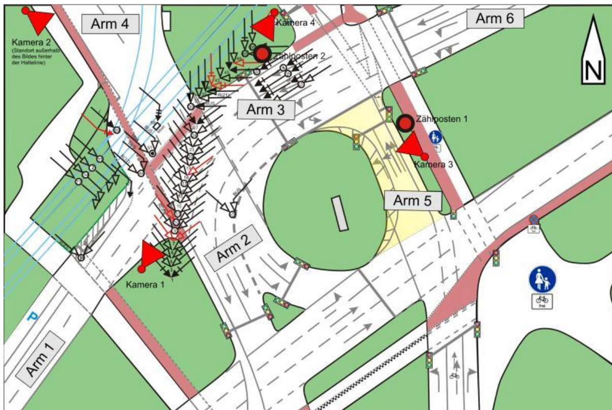
Abbildung 78: Knotenpunkt 6 – Unfalldiagramm, Kamerastandorte und Zählposten (Bereiche mit Änderungen sind gelb hinterlegt. Die Unfälle 65, 66, 67, 69, 73 fanden nach bzw. im Jahr der Umsetzung der Maßnahmen statt. Numerisch nicht aufgeführte Unfälle beziehen sich auf andere Bereiche des Knotenpunktes)
