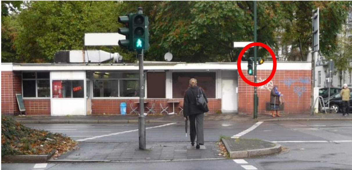
Abbildung 62: Knotenpunkt 2 – Hilfssignalgeber (gelbes Blicklicht) an Fußgängerfurt
