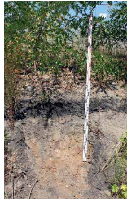
ABBILDUNG 3.5–2 ▶ Städtebau vernichtet natürlich gewachsene Böden und neue Böden bilden sich aus umgelagerten und technogenen Materialien. Links: Bodenarbeiten für eine Kabelverlegung. Mitte: Boden unter einer Straße mit grauer Zementschicht. Rechts: Schlackeschicht (schwarz) im Boden eines ehemaligen Rangierbahnhofs. (Fotos: aus Karlsruhe, Stefan Norra)
