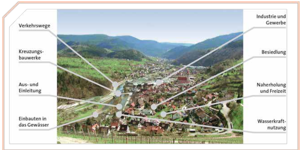
ABBILDUNG 3.5–7 ▶ Technisch ausgebautes innerstädtisches Gewässer (Murg bei Gernsbach, Baden-Württemberg) mit exemplarischer Kennzeichnung bestehender Nutzungen. (Eigene Darstellung/Boris Lehmann)
