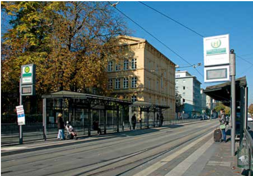
Zur ansprechenden Gestaltung einer Haltestelle gehören ein Warthäuschen mit Sitzgelegenheiten, ein Papierkorb und ein dynamisches Fahrgastinformationssystem
