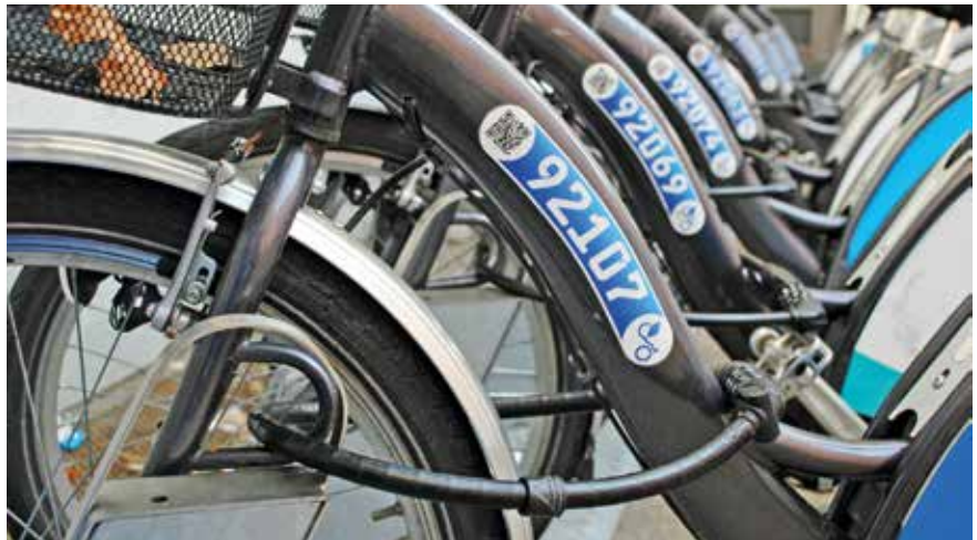
Fahrradverleihsystem Augsburg: Die Öffnung des Zahlenschlosses erfolgt über einen Code, der auf dem Bedienterminal oder auf dem Handy angezeigt wird
