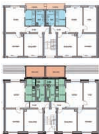
Grundriss vor (oben) und nach der Sanierung
