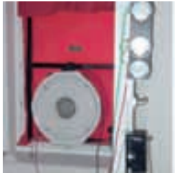
Blower-Door-Test zur Prüfung der Gebäudedichtheit
