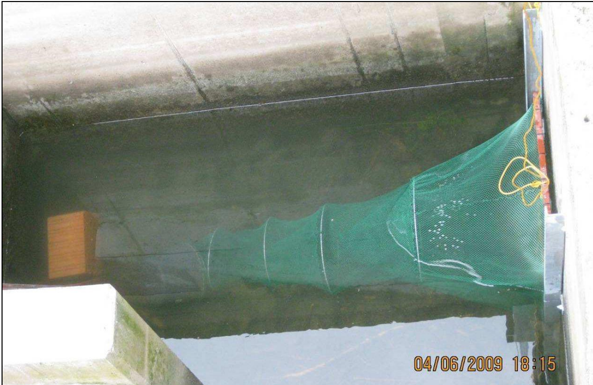
Abb. 5.26: Von SCHMALZ (2010) eingesetzter Hamen zur Beprobung des Bypasses des Wasserkraftwerks Walkmühle an der Werra
