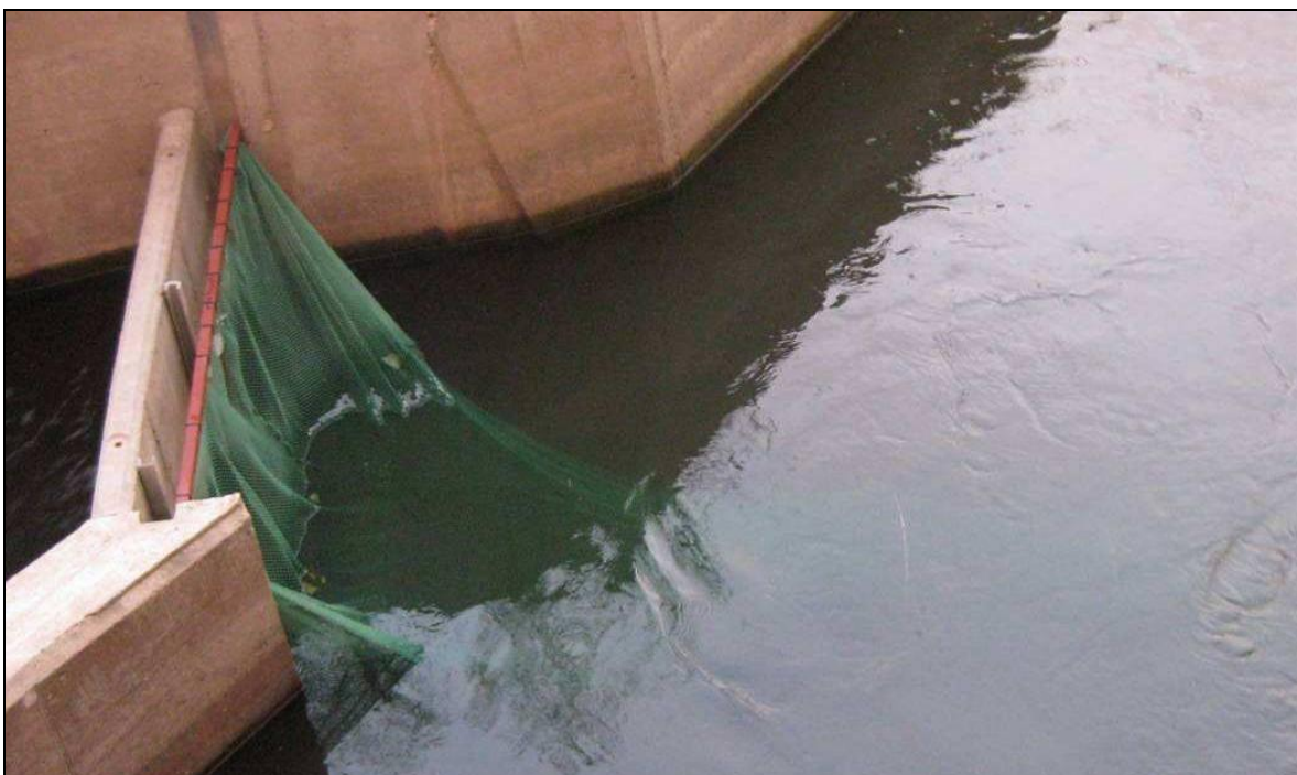
Abb. 5.27: Von SCHMALZ (2010) eingesetzter Hamen zur Untersuchung der Fischabwanderung über die Fischaufstiegsanlage am Wasserkraftwerk Walkmühle an der Werra
