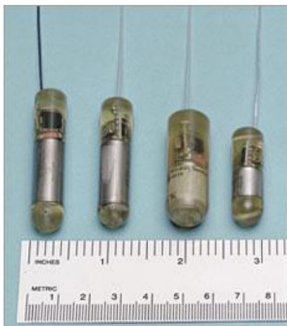
Abb. 5.88: Radiotelemetrische Sender unterschiedlicher Größe und Reichweite
