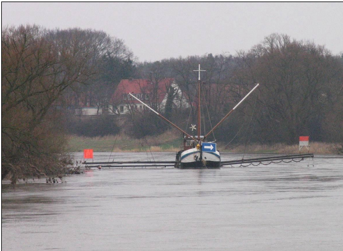
Abb. 5.10: Schokker des Fischereibetriebs der Gebr. Dobberschütz, in Ruhestellung mit angehobenem Unterbaum (Ansicht in Fließrichtung)
