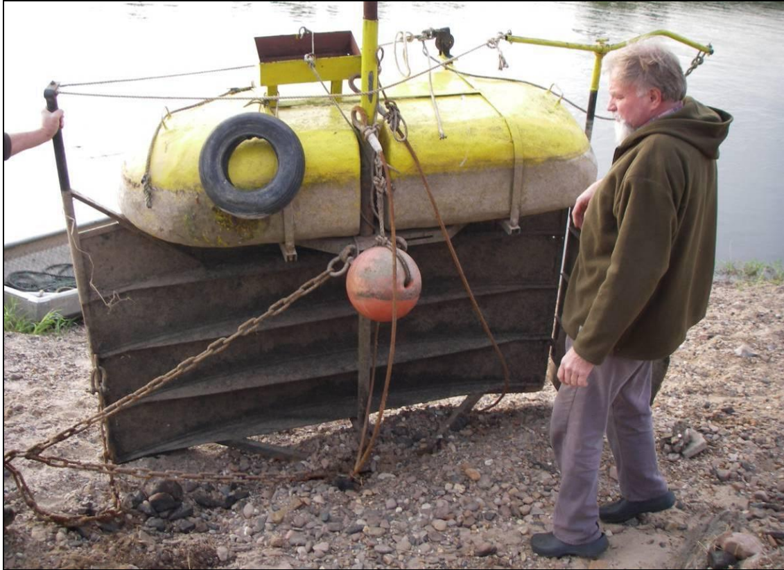
Abb. 5.8: Scherbrett des Hamens des Fischereibetriebs Gebr. Dobberschütz
