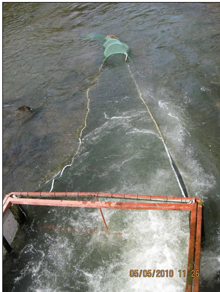
Abb. 5.18: Hamen von 5 m Länge zur Beprobung des Abflusses einer Wasserkraftschnecke an der Werra (SCHMALZ 2010)
