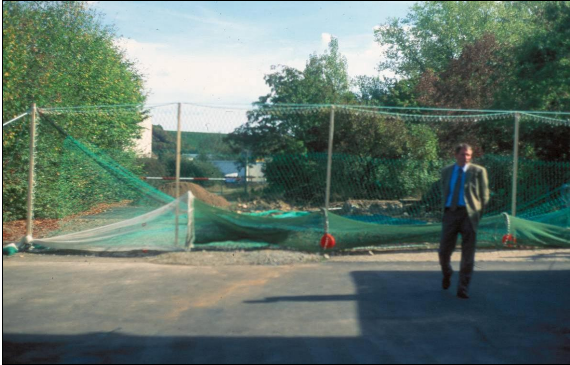
Abb. 5.22: Einer der am Kraftwerk Dettelbach am Main (Bayern) zur Untersuchung der Turbinenmortalität eingesetzten Hamen, zum Trocknen aufgespannt
