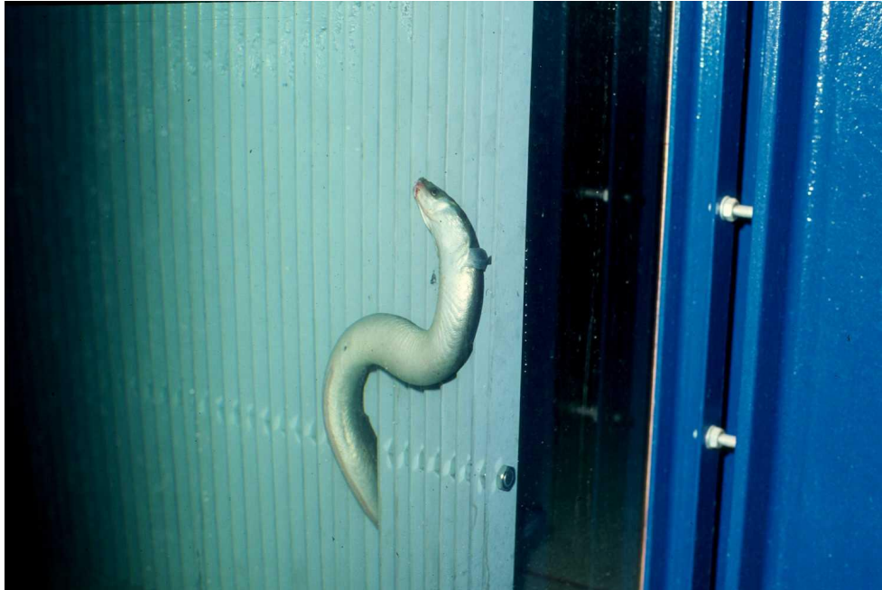
Abb. A.2: Aal, der bei einer Anströmgeschwindigkeit > 0,5 m/s an einen 20 mm-Rechen angepresst wird (ARBEITSGEMEINSCHAFT GEWÄSSERSANIERUNG 1998)
