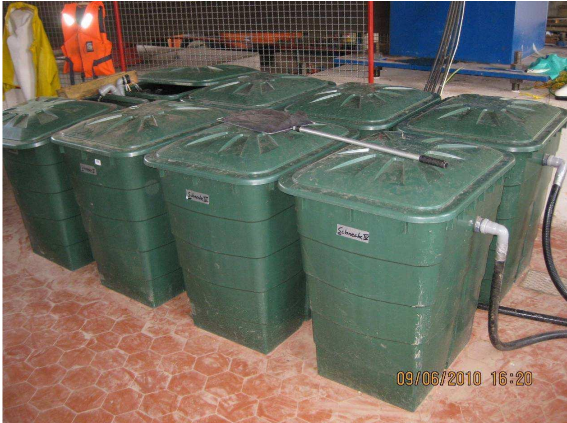
Abb. 5.55: Hälteranlage zur Ermittlung der verzögerten Mortalität von Fischen nach der Passage verschiedener Abwanderkorridore an der Walkmühle an der Werra in Meiningen (SCHMALZ 2010)
