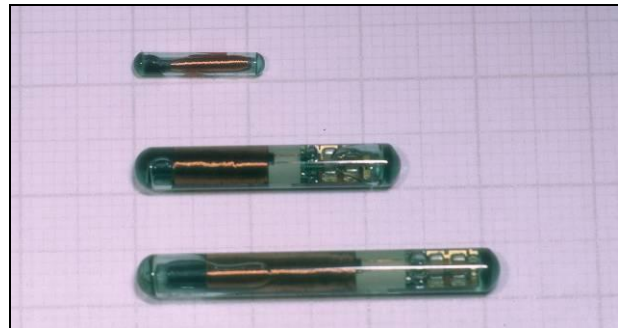
Abb. 5.75: Transponder verschiedener Hersteller:
