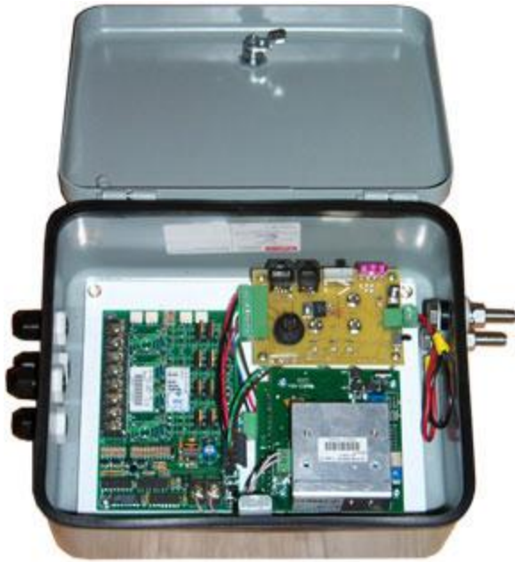
Abb. 5.82: Lesegerät für den gleichzeitigen Betrieb von bis zu 4 Antennen, Transformator und Datenaufnahmegesät müssen separat untergebracht werden
