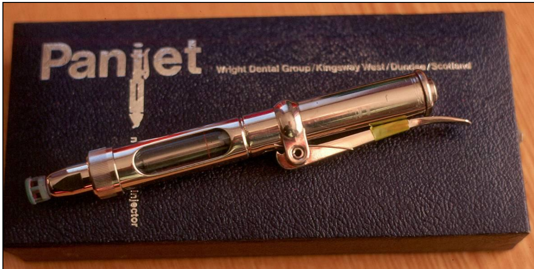
Abb. 5.63: Der Panjet, ursprünglich als nadelloses Injektionsgerät für medizinische Zwecke entwickelt, wird in der Fischereibiologie zur Markierung von Fischen genutzt
