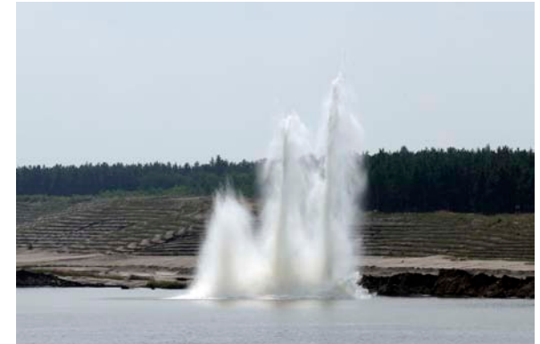
Testspregung zur Prüfung der Böschungsstabilität im Lausitzer Seenland (Brandenburg/Lausitz) Foto: Archiv LMBV mbH
