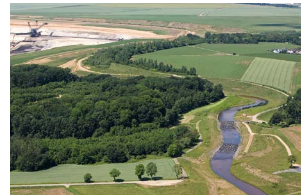
Inden im Tagebaubereich Inden – naturnahe Ausführung einer Flussverlegung (Nordrhein-Westfalen) Foto: Archiv RWE Power
