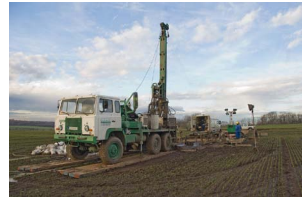
Lagerstätte Lützen-Nord – Erkundungsbohrung (Sachsen-Anhalt) Foto: Archiv MIBRAG mbH
