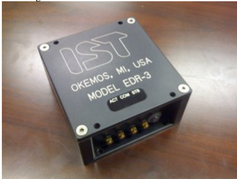
Figure 29. IST EDR-3 Tri-Axis Accelerometer
