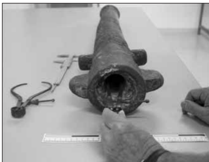
Figura 7. Midiendo el diámetro de la parte trasera del ánima con un compás de interiores. Se observa el hueco para el alojamiento del másculo, las gruesas “orejas” donde se trincaba la braga, los muñones y la curvatura de la boca de la caña.
