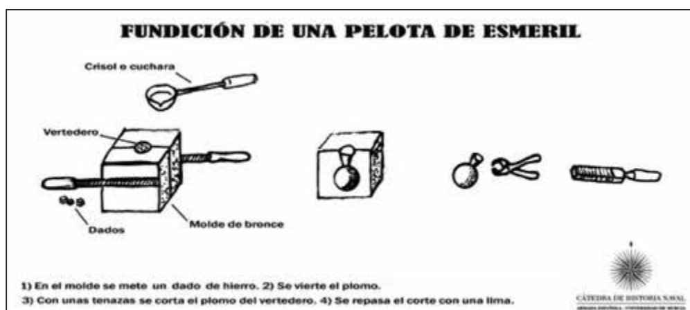
Figura 16. Explicación gráfica sobre cómo se funde la pelota de un esmeril.
