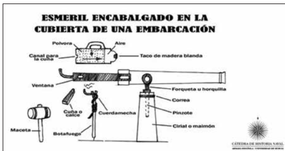
Figura 15. Esmeril encabalgado en la cubierta de un buque.
