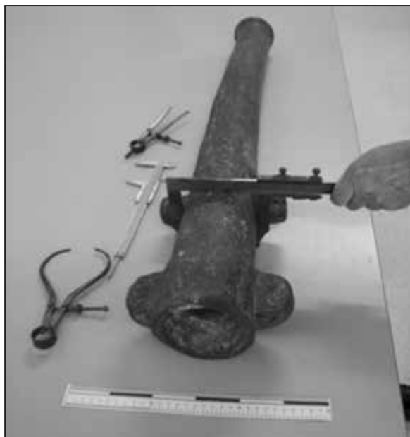
Figura 6. La caña del esmeril de braga analizado durante el proceso de medición. Se aprecia la torsión de la parte delantera.
