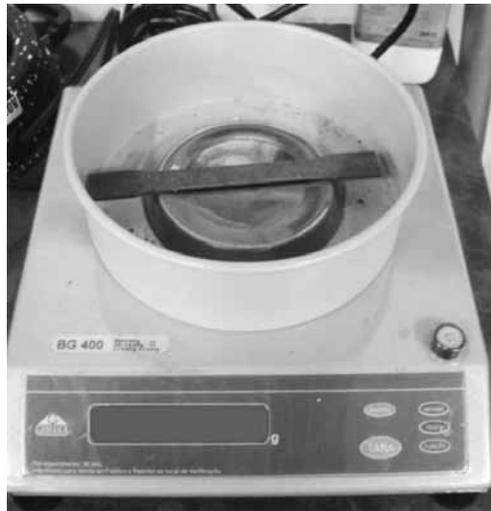
Figura 3 - Corpo de prova sendo pesado na balança de precisão.
