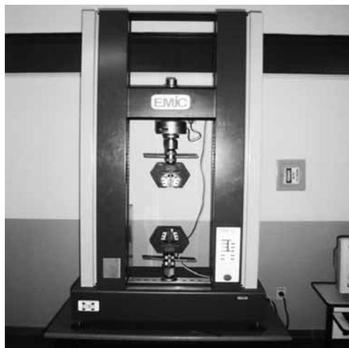
Figura 5 - Máquina de tração do laboratório de Ensaios do UniFOA.
