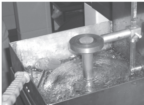
Figura 5. Retirada do corpo-de-prova do forno e realização do ensaio Jominy.
