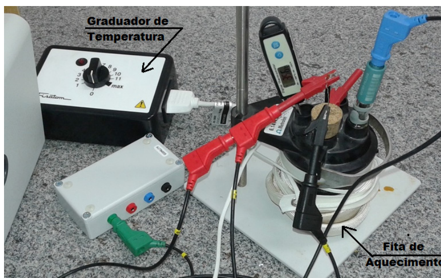
Figura 7 – Graduador de temperatura e fita de aquecimento usado para o aquecimento da solução de cloreto férrico nas temperaturas de 35°C e 50°C.
