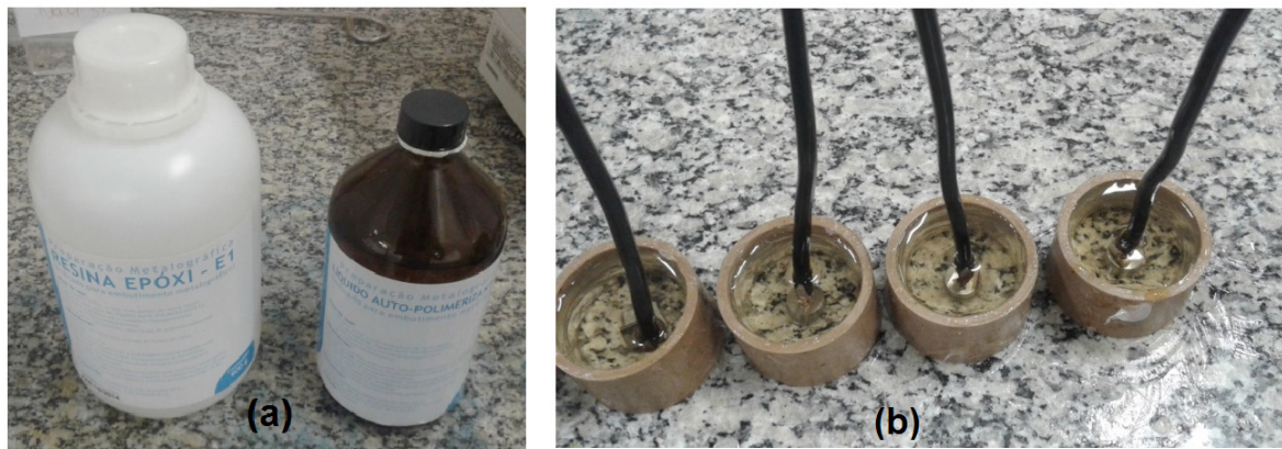
Figura 2 – (a) Resina de embutimento e (b) amostras sendo embutidas com a resina.
