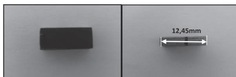
Figura 3 – Amostras do composto Mg-B(20%) confeccionadas para ensaios de dilatometria.
