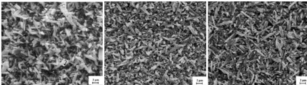
Figura 2 – Microestruturas das cerâmicas: de  $Si_3N_4$  Sinterizadas (a)  $Y_2O_3$ , (b)  $CTR_2O_3$ , (c)  $CeO_2$ .
