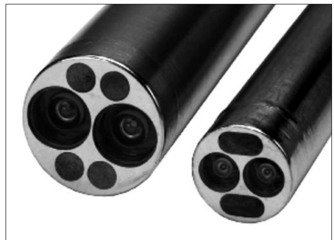
Rycina 4. Narzędzia do robota DaVinci 12 mm i 8 mm. Trójwymiarowy obraz powstaje przez umieszczenie dwóch kamer na laparoskopie.
