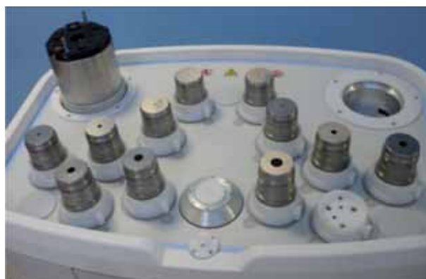
Ryc. 2. Zestaw 12 stałych kolimatorów średnicy 5-60 mm
