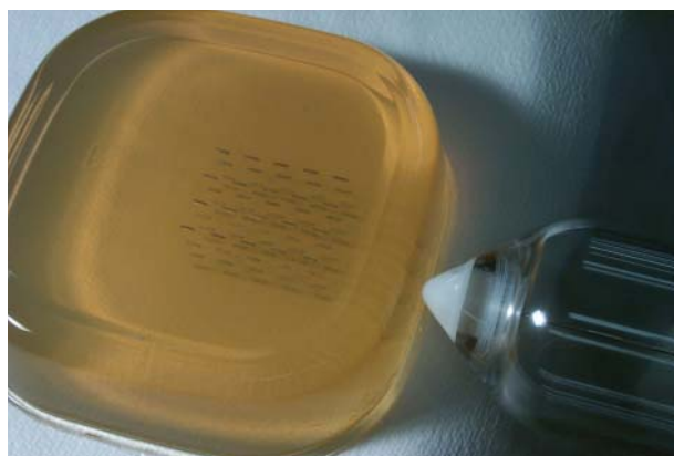
Ryc. 4. Eksperyment z umieszczeniem „źródeł” ze stali nierdzewnej w fantomie tkanki
