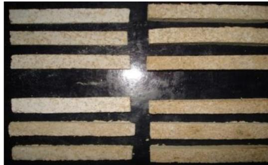
Gambar 3. Spesimen uji bending komposit sekam padi bermatrik *urea formaldehyde*.
