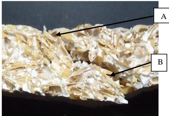
Gambar 8. Foto struktur makro pada spesimen uji bending
