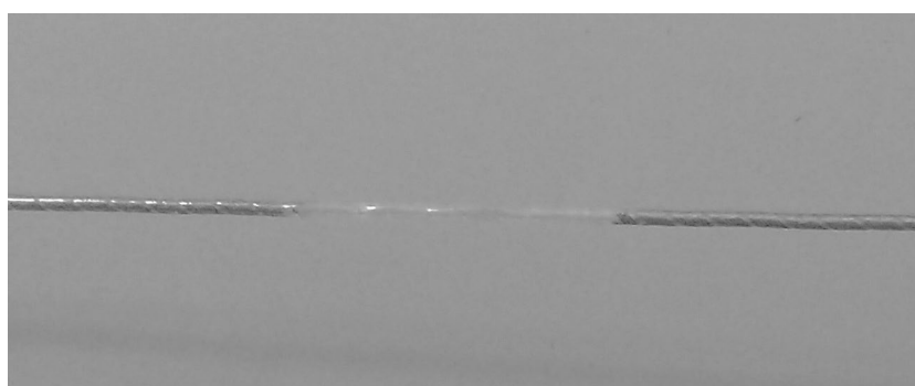
Rycina 7. Zdjęcie uwidaczniające przerwanie przewodu łącznika wewnętrznego stymulatora impulsów (8.2017 r.)
