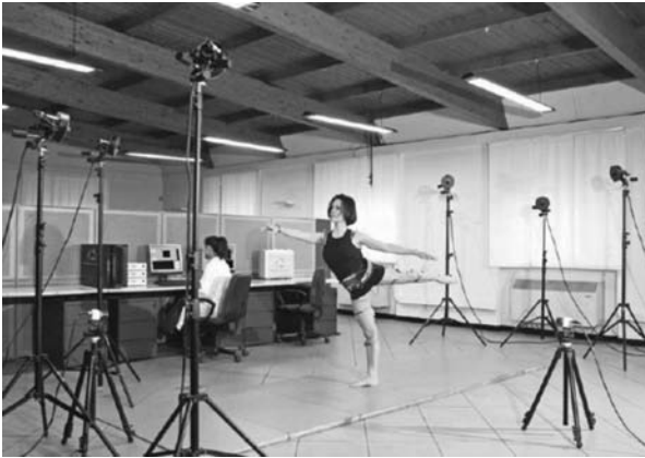
Rycina 2. Pletyzmografia optoelektroniczna wykorzystywana jest także w analizie ruchu. System oparty na 6 kamerach (3 z przodu, 3 z tyłu) jest w tym przypadku wsparty 2 mniejszymi. Zdjęcie zaczerpnięto z materiałów BTS Spa., www.bts.it
