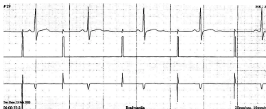
Ryc. 6. Stymulator AAI (50/min). Nieskuteczna stymulacja przy zachowanym czuwaniu.
