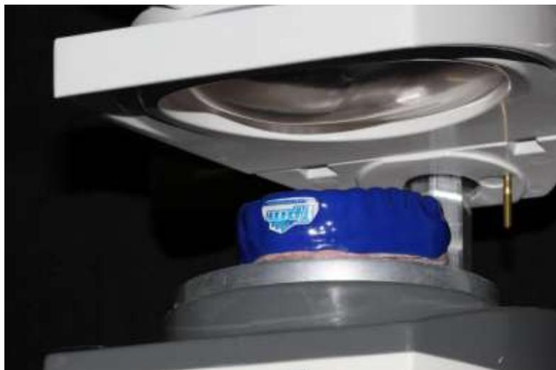
**Figura 8:** Segunda folha submetida a aumento da temperatura e vácuo.
