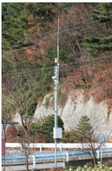
写真2 . 富士吉田市旭地区に設置されたサル自動接近警報システム
