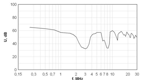
В качестве исходных данных для компьютерного анализа уровней ЭМП в различных условиях работы усилителя использовались результаты измерений, выполненных ранее [9]. На основании экспериментальных данных установлено, что уровень ЭМП усилителя класса D снижается при наличии входного сигнала, но мало зависит от коэффициента нелинейных искажений. Повышение частоты усиливаемого сигнала снижает на 5-10 дБ уровень ЭМП в области частот до 2МГц.
