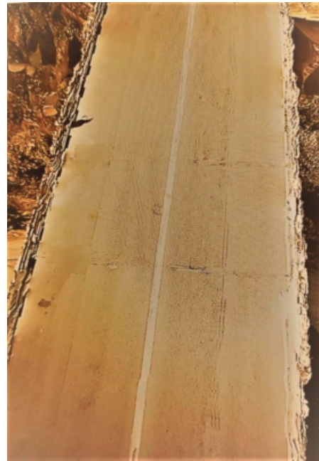
Fig. 6 - Cambio cromatico per far risaltare le difettosità all'analisi visiva (fonte: propria elaborazione)
