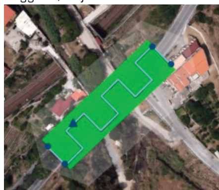
Fig. 3a - Screen dello schermo della ground station con piano di volo (fonte: propria elaborazione)
