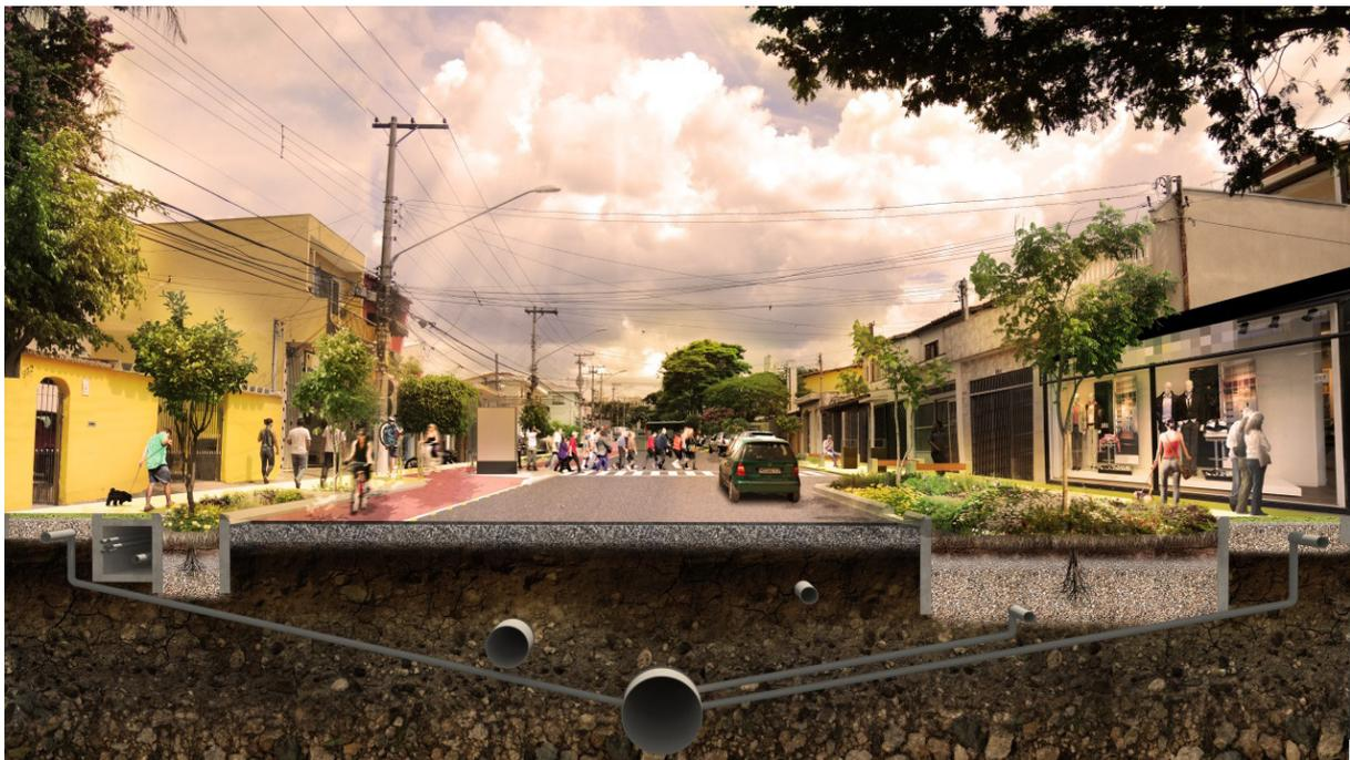
**Figura 03** – Exemplo de instalação de LID em via coletora. Fonte: FCTH, 2017.
