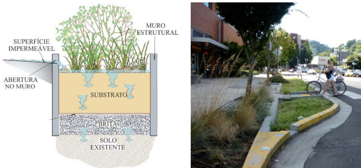
Figura 4 – Diagrama esquemático de canteiro pluvial de infiltração.
