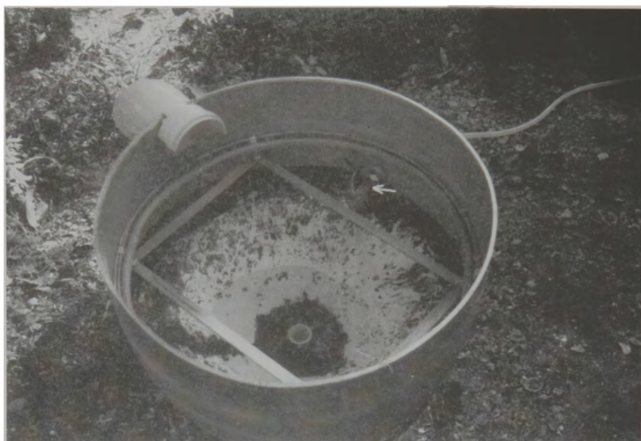
Fig. 4 – Cédula de flotação: visão de cima, mostrando a entrada de água (flecha).
