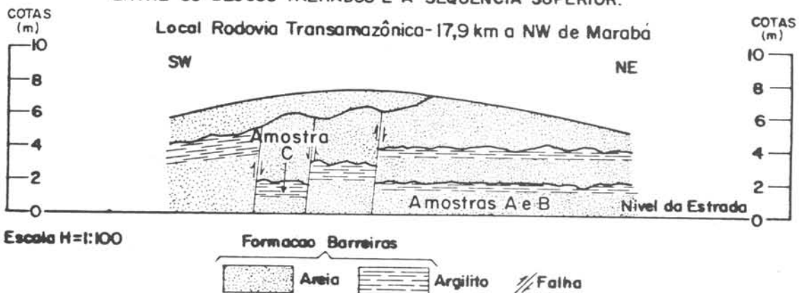
FIGURA 7 (ESQUEMA 31) - ALTERNÂNCIA AREIA-ARGILA COM FALHA, NA FORMAÇÃO BARREIRAS, MOSTRANDO TAMBÉM CONTATO EROSIVO ENTRE OS BLOCOS FALHADOS E A SEQÜÊNCIA SUPERIOR.
