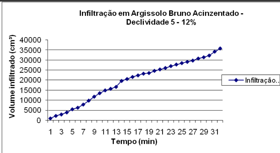
Gráfico 7. Gráfico da taxa de infiltração em Argissolo Bruno Acinzentado – declividade superior a 5%.
